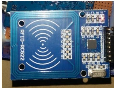
**Fig. 3:** RFID MF RC522 Reader [24]
