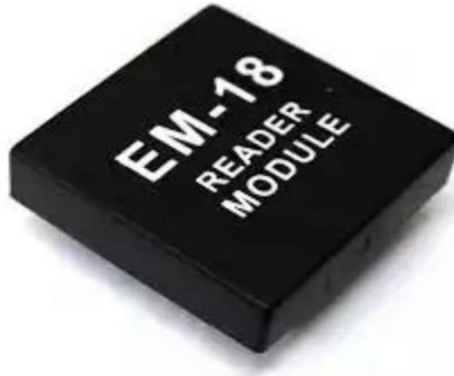
**Fig. 1:** RFID Reader Module[22]
